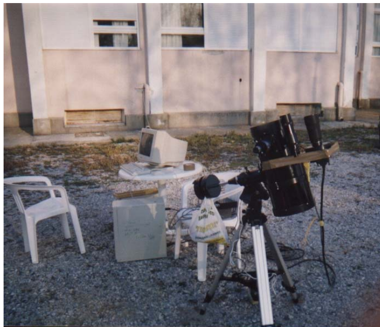
Σχήμα 3.9. Διακρίνονται το τηλεσκόπιο Celestron GN8, η CCD Apogee 10 και η μικρή σακούλα δεμένη στα αντίβαρα που περιέχει τα τουβλάκια, προκειμένου να ισορροπήσει το τηλεσκόπιο.
