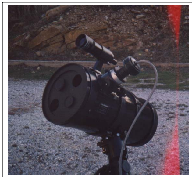
Εικόνα 1.7. Το τηλεσκόπιο GN-8 Celestron που χρησιμοποιήσαμε στον Χολομώντα, διακρίνεται η μάσκα και η ST4 CCD
