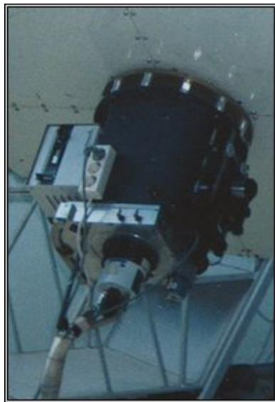
Σχήμα 2.4.1: H Series 200 Camera System CCD κάμερα
